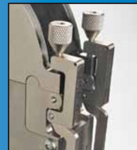
Réglage de la pression des ouvertures basculantes par vernier.
