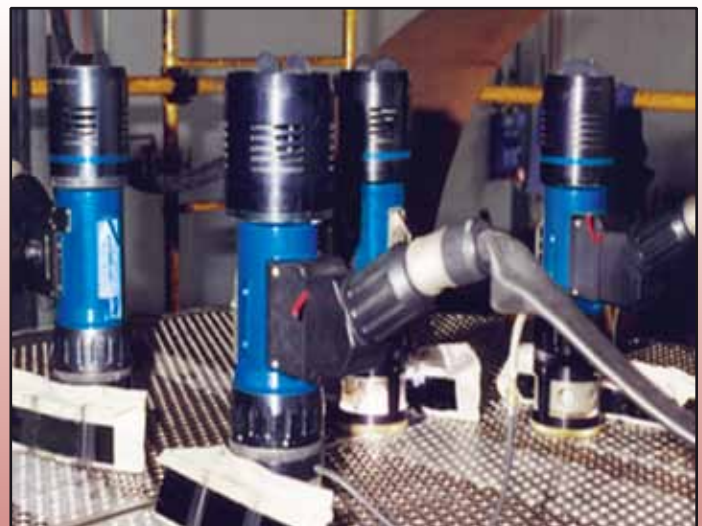
Modèle 430 - Application : soudures au plafond
