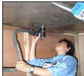
Modèle 430 - Application : soudures au plafond
